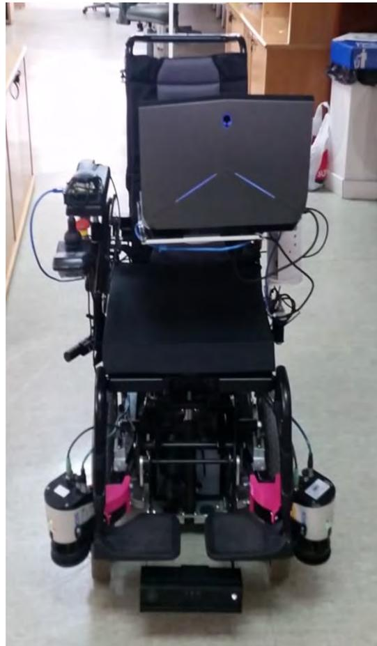
Figura 3: Silla con el ordenador portátil, el sistema sensorial y el pulsador de desconexión en caso de emergencia.
