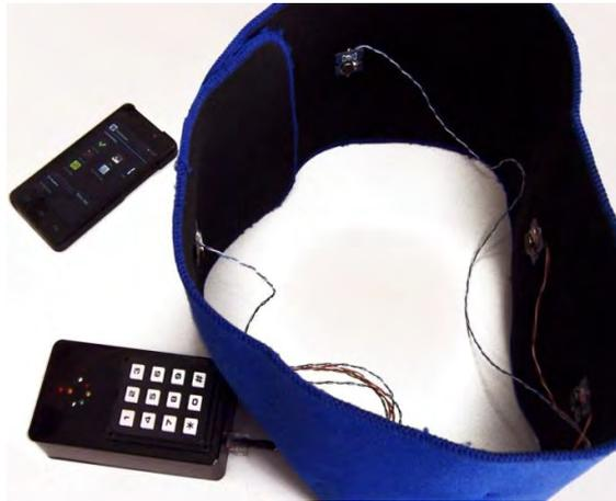
**Imagen 1. Partes del sistema de comunicación para sordociegos. En la fotografía se observan todas las partes del sistema que se explicarán a continuación: *smartphone*, teclado adaptado y cinturón de estimulación sensorial táctil.**
