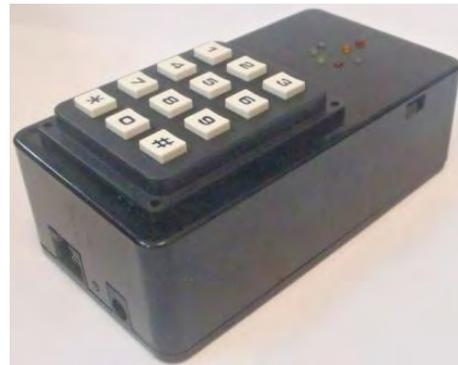
**Imagen 4. Aspecto del dispositivo en que se integra la interfaz aferente, el sistema de procesado, la batería de alimentación y su sistema de carga.**
