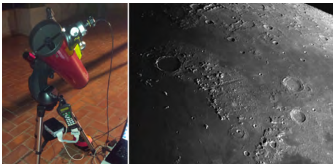
Figura 12. Sistema de control del telescopio SkyProdigy 130 y captura de una imagen obtenida.
