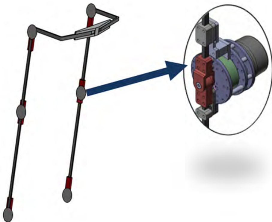
Imagen 5. Sistema de control del movimiento de las articulaciones del exoesqueleto CP-Walker.
