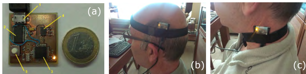
Figura 2. Implementación interfaz hombre-máquina (a) y diferentes partes de cuerpo donde ha sido probada (b-c).
