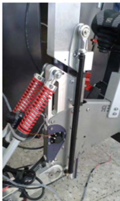
Imagen 3. Sistema de control de descarga del peso CP-Walker.
