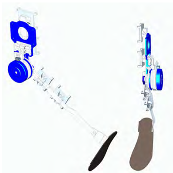
Figura 6 Diseño en CAD de la rodilla MB-ActiveKnee.
