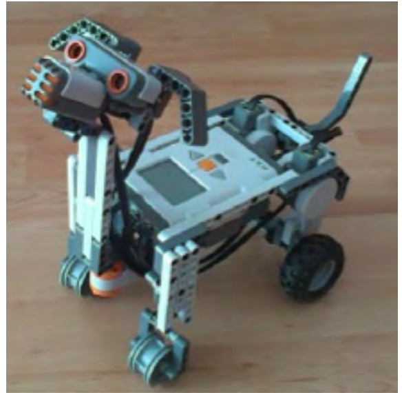
Figura 11. Robot Lego Minstorm implementado para su control por una persona con discapacidad.
